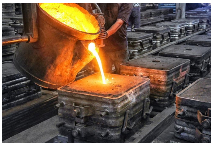
شکل (۱-۱) بارریزی فلز در قالب
